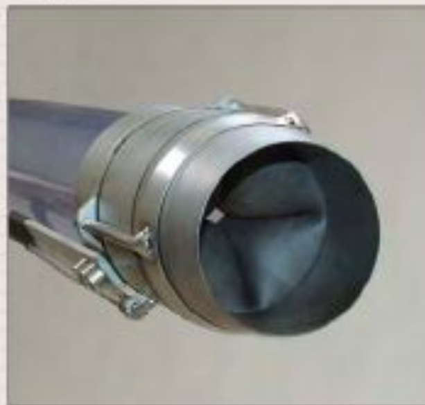
Режущая головка с надутой мембраной
