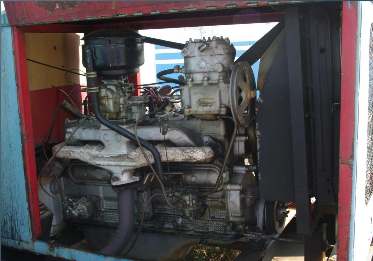
Подъемник имеет шестицилиндровый двигатель внутреннего сгорания, который приводит в движение лебедку. К нему пристыкованы сцепление, коробка передач, дальше идет карданный вал на редуктор.
