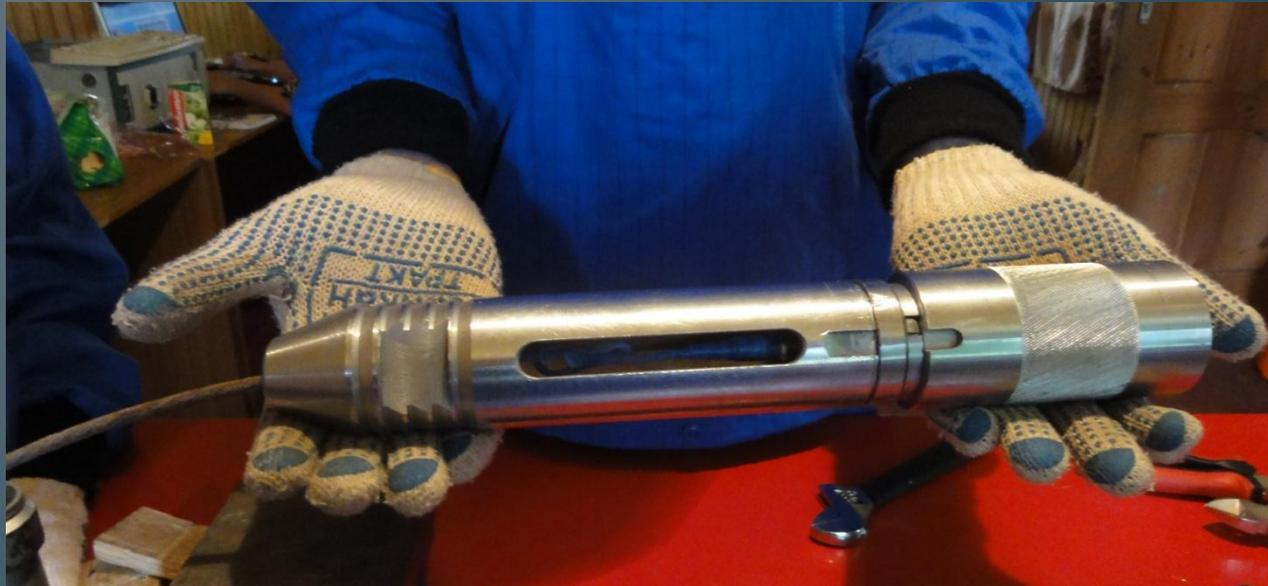
Кабельная головка служит для соединения геофизического кабеля и прибора.
