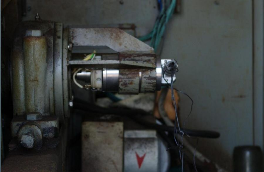
Важный элемент каротажного оборудования – это коллектор. Он позволяет снять сигнал и запитать электрической энергией приборы. Коллектор состоит из двух частей, одна из них вращается вместе с лебедкой, а вторая закреплена. Внутри находится цилиндр с нанесенными дорожками и щётки, которые снимают сигнал.
