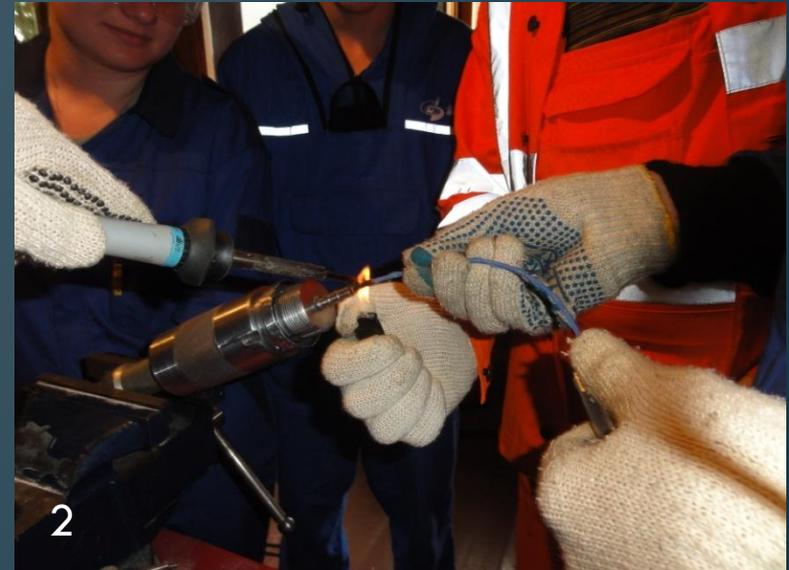
1.Конец жилы очищаем от изоляции и вводим в отверстие свечи, чтобы изоляция была в упор подведена к свече (для предотвращения изгиба и излома медных проводников).
