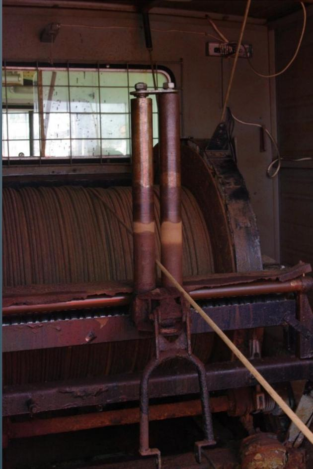
Для правильного укладывания кабеля при вращении лебедки используется привод водильника. На водильнике можно размещать дополнительные устройства, например, счетчик глубины. Остановка лебедки производится с помощью тормозных лент, которые прижимаются к барабану, и с помощью дополнительной пневматической системы.
