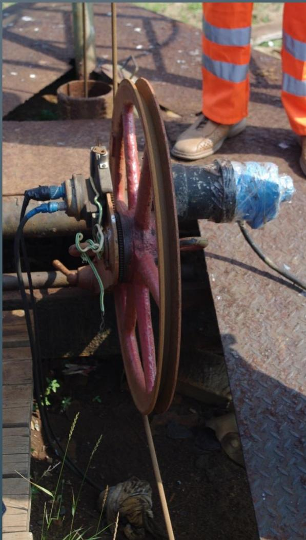
Для спуска в скважину и направления кабеля служит специальное устройство — блок-баланс. С помощью ролика блок-баланса определяют длину опущенного в скважину кабеля. Для этого на нем устанавливают счетчик глубины. Раньше использовали аналоговый счетчик, называемый сельсин. В настоящее время пользуются цифровыми счетчиками. Для корректировки глубины на кабель каждые 10 м наносят магнитные метки, считываемые магнитоуловителем.
