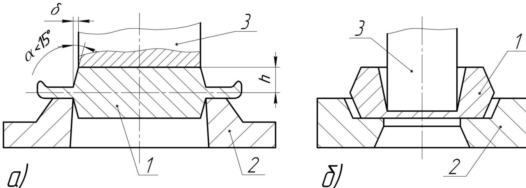
**Рисунок 11.1** – Схема удаления облоя (а) и перемычки (б) в поковках
