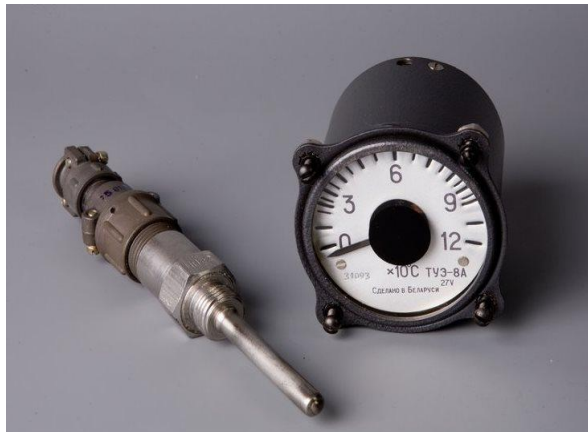
Термоуказатель ТУЭ-48 с терморезистором ПП-2
