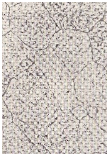
сплав Al-Cu (4 % Cu), x1000
