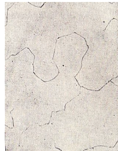
сплав Al-Cu (4 % Cu), x100
