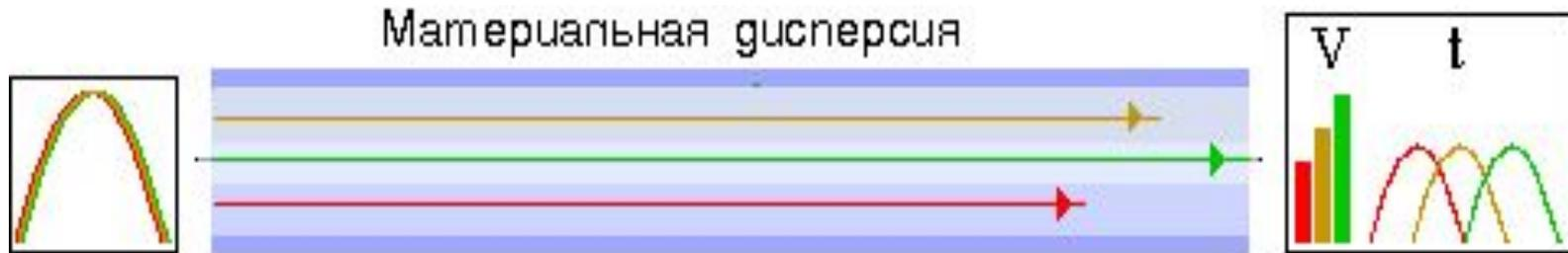
Скорость преодоления расстояний волной зависит не только от частоты, но и от плотности среды распространения. Показатель преломления –  $n$ , при более тщательном рассмотрении, зависит от длины волны. Вследствие этого волны, имеющие разную длину, обладают разными скоростями распространения и оказываются в приемнике в разное время.
