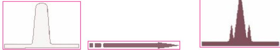
Меняя форму профиля показателя преломления (**глубину провалов**), существует возможность создавать NZDS-волокна как с положительной, так и с отрицательной величиной дисперсии, что открывает возможность сбалансировать дисперсию в оптической линии без использования дополнительных устройств.
