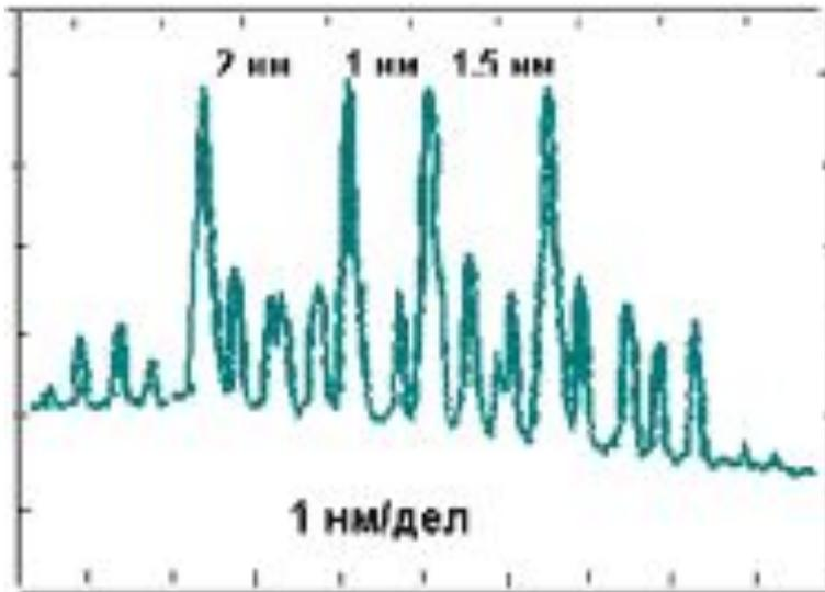
**Волокно со смещенной (нулевой) дисперсией. Спектр сигнала после прохождения 25 км искажен четырёхволновым смешением.**
