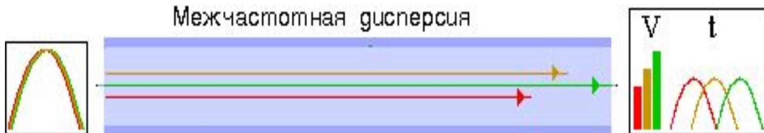
Источники излучения генерируют не одну длину волны, а некоторое их количество, определяемое спектром излучения -  $\Delta\lambda$ . Согласно законам физики более короткие волны распространяются быстрее, а следовательно волны достигают конца световода в разные моменты времени. Если изначальный световой импульс содержит некоторое множество входящих в световод волн с разной частотой, то он раскладывается на множество отдельных волн, достигающих приемник в разное время.
