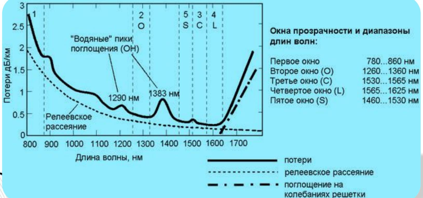
**Релеевское рассеяние**, значение которого убывает пропорционально четвертой степени длины волны:  $B_{\text{рел}} = \alpha_{\text{рел}} \lambda^{-4}$
