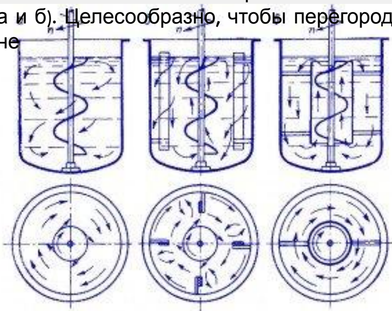
Примеры различных вариантов установки шнековых мешалок:
