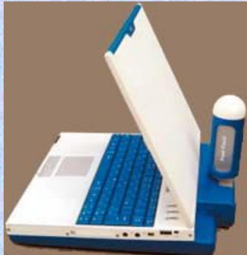
Ноутбук с топливным элементом, работающем на метаноле, созданный компанией «NEC Corporation». Размеры ноутбука 270x270x40 мм, масса 2 кг. Время работы на одной зарядке (0,3 л метанола) около 2 ч.
