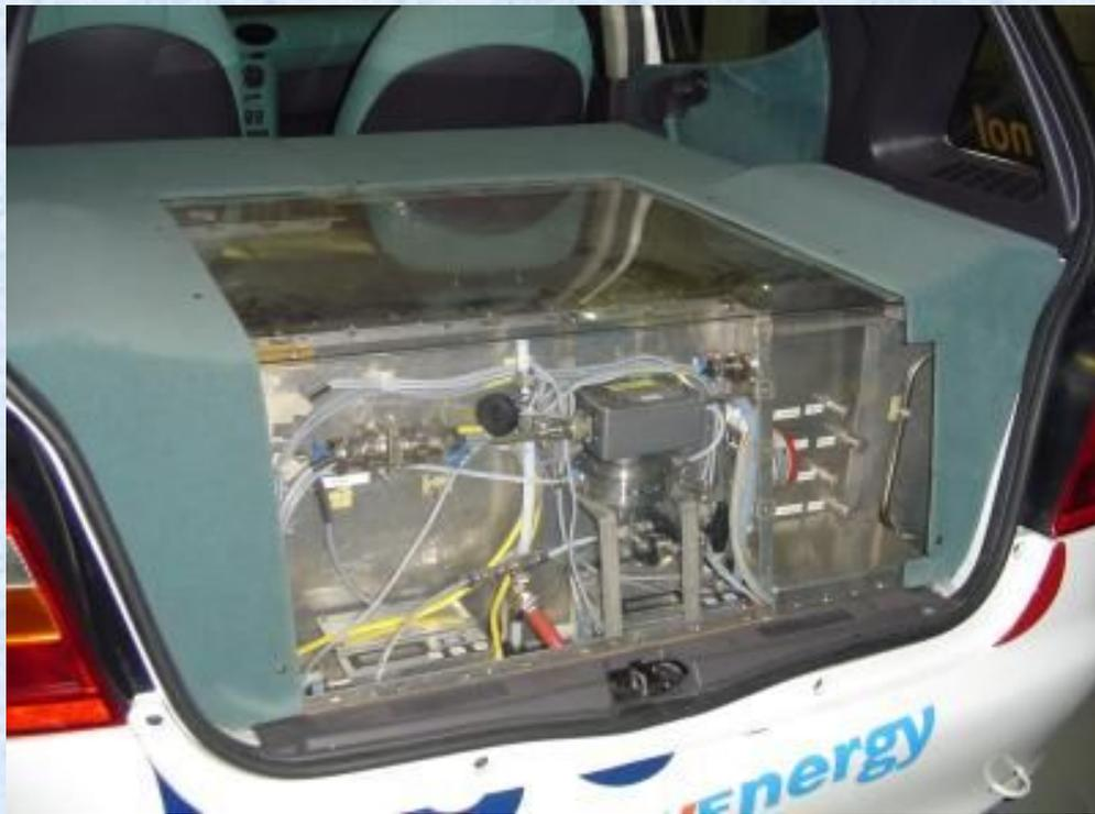
**Метанольный топливный элемент в
