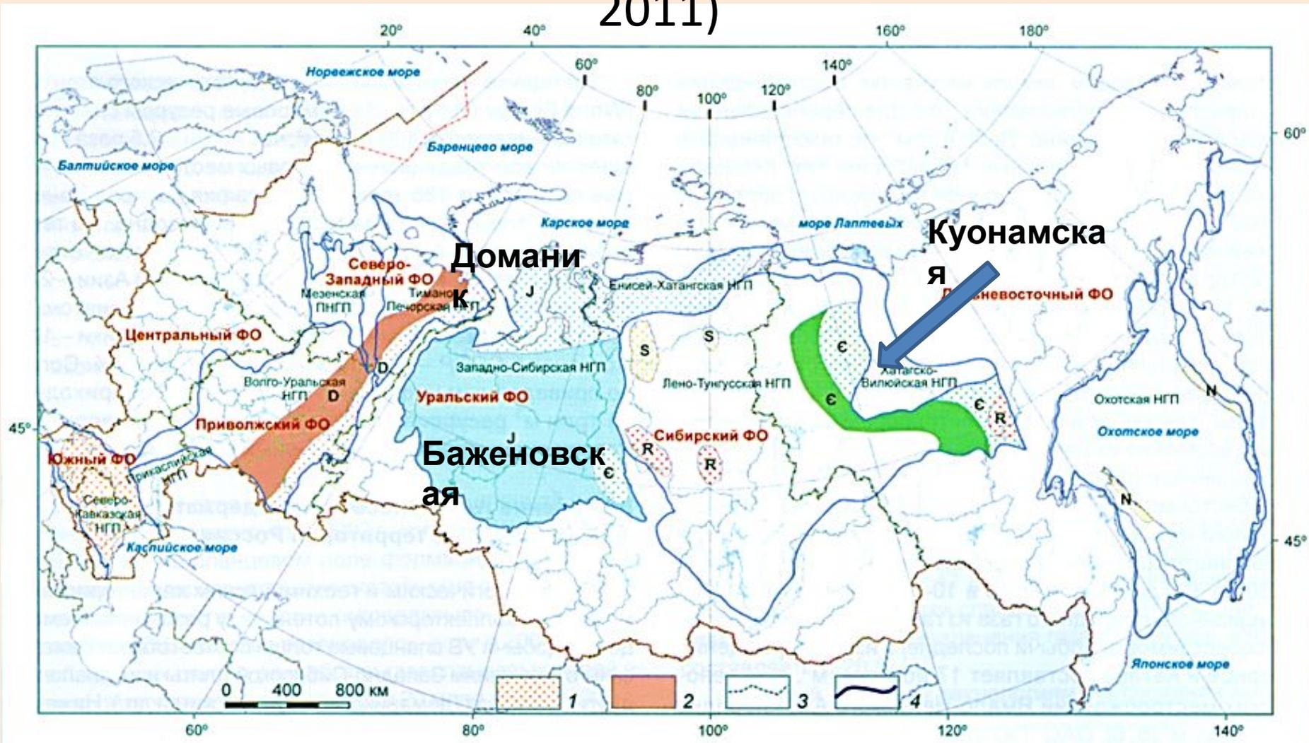
Условные обозначения: 1 – с газовым насыщением (крап); 2 – с нефтяным насыщением (цвет соответствует возрасту по геохронологической шкале); 3 – границы федеральных округов; 4 – границы нефтегазоносных провинций
