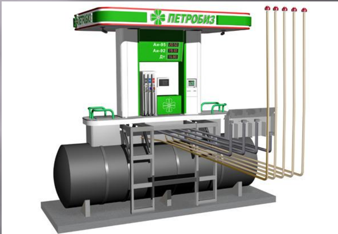
Устройство заправочной колонки с подземным резервуаром
