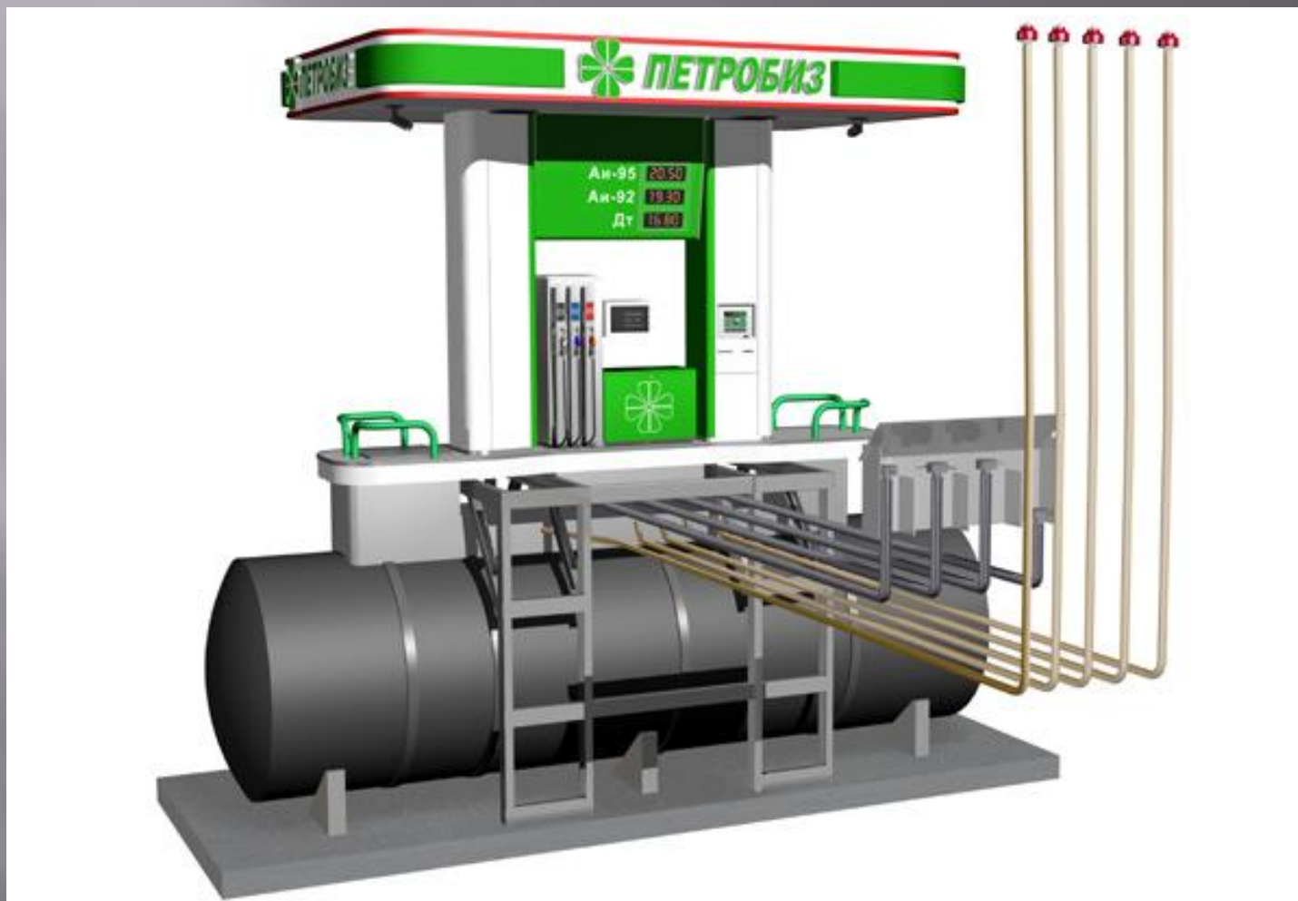
Устройство заправочной колонки с подземным резервуаром
