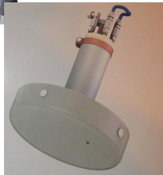
Конструкция источника на индуктивно-связанной плазме
