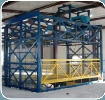
Грузовой лифт представляет собой грузоподъемное устройство прерывистого действия для подъема и спуска грузов. Грузоподъемность — от 150 кг до 5 т.
