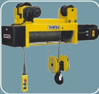
Электрическая таль — механизм с электроприводом для вертикального и горизонтального перемещения груза, подвешенного на крюк. Горизонтальное перемещение осуществляется вдоль подвесного однорельсового пути. Управляют ею с помощью кнопочного механизма. Выпускается грузоподъемностью 0,5; 1; 5 и 10 т. Рассчитана на высоту подъема груза от 4 до 30 м.
