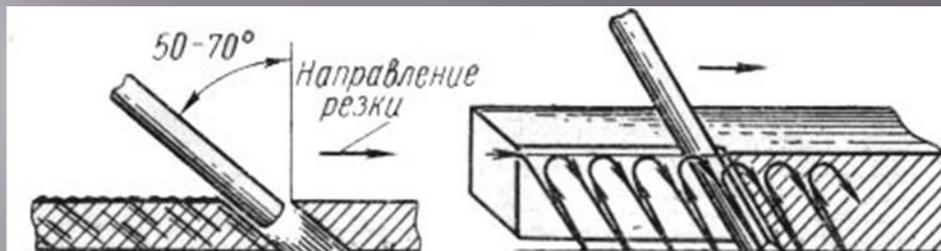
Рис.5.1.1. Схема электродуговой резки в нижнем положении:
