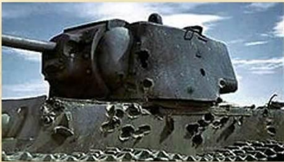
Танк КВ-1 с повреждениями (более сотни попаданий)
