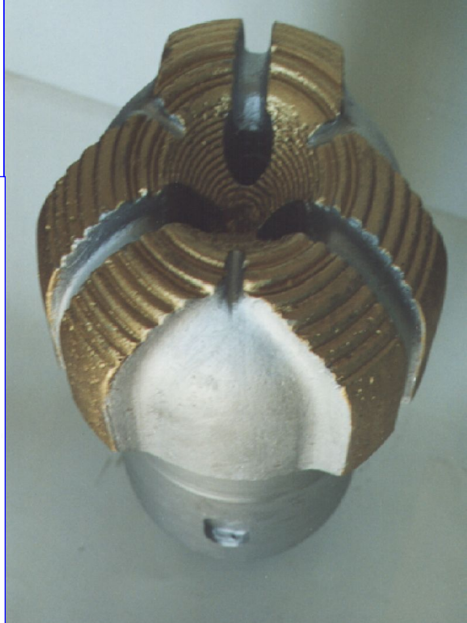
Рис. 2.3. Алмазное буровое долото типа ДКСИ 188,9С6, оснащенное синтетическими алмазами СВС-П.
