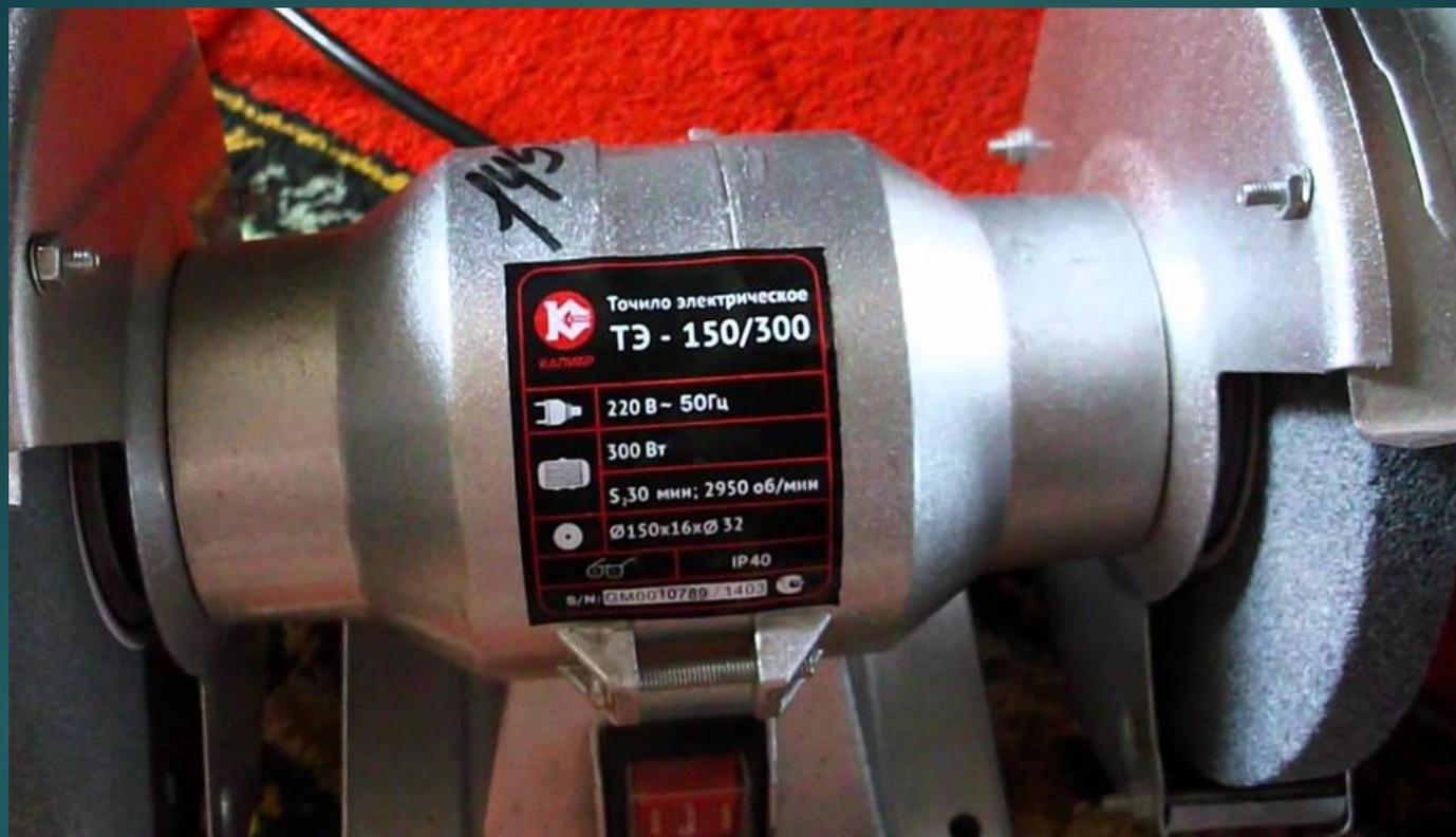
Точильный станок предназначен для обточки, шлифовки и полировки предметов
