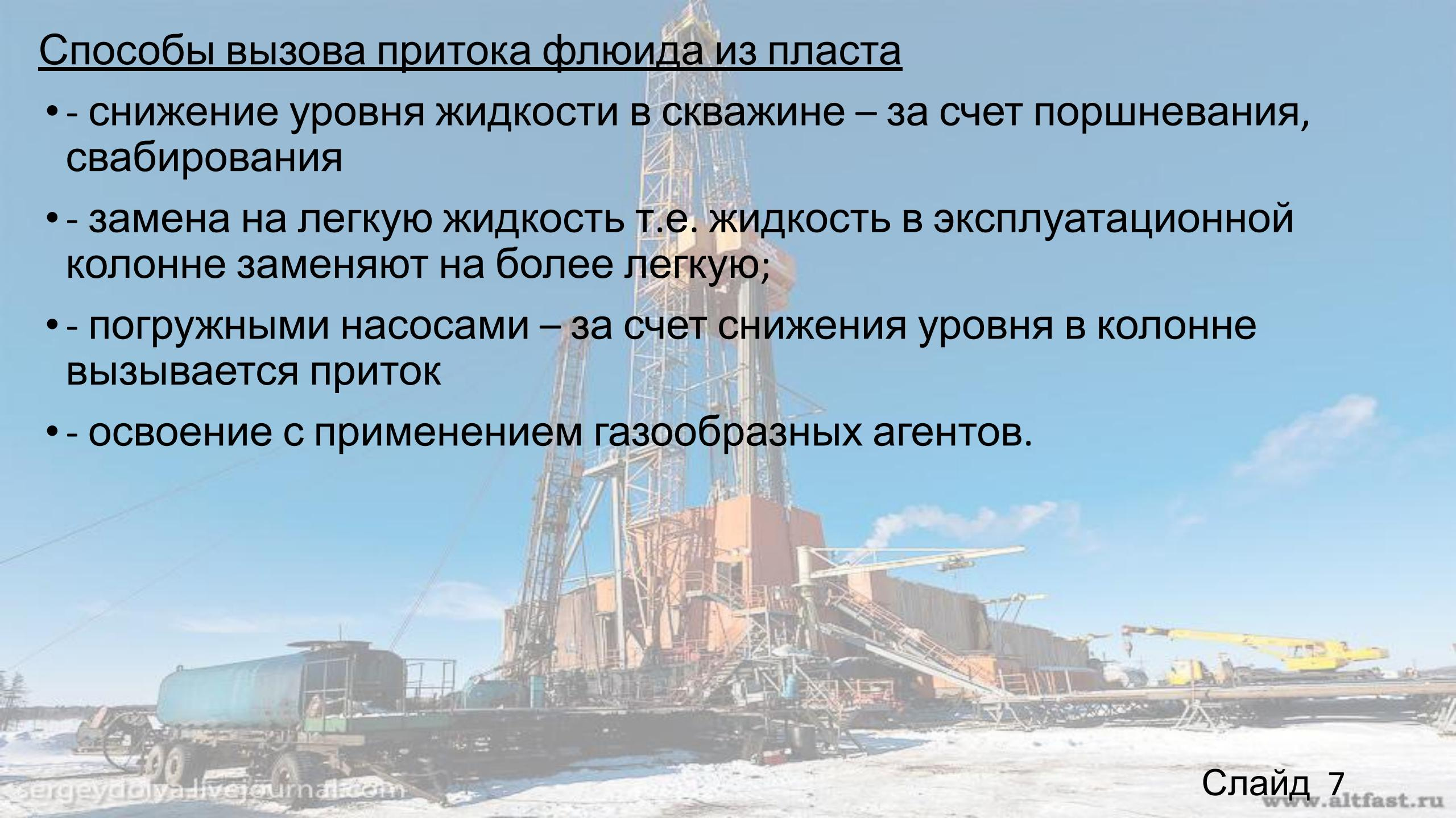
Вызов притока методом замещения жидкости в эксплуатационной колонне, с целью снижения ее плотности и снижение противодавления на пласт – способ 1.
