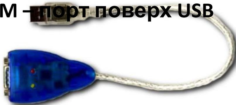
1. Вариант – приобретение специального кабеля переходника USB – COM с специальным драйвером. При установке драйвера в системе появляется виртуальный COM – порт, работающий поверх USB. Обращение к этому порту осуществляется с помощью функций доступа к COM – порту.
