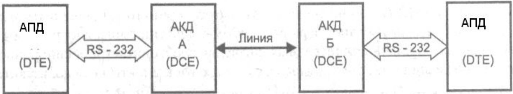
Рис.2 Полная схема соединения по RS-232C
