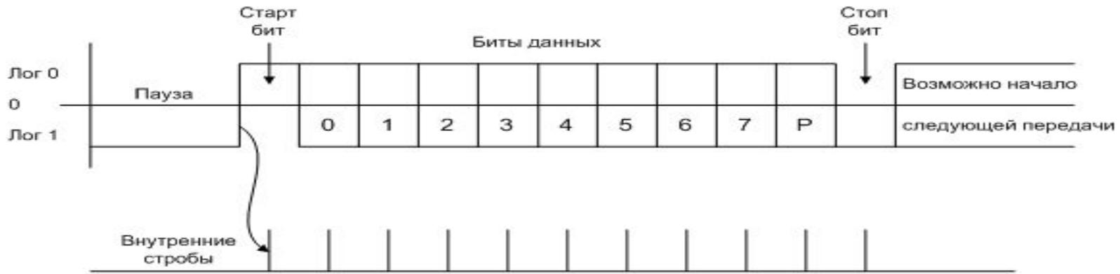
Рис. 1. Формат асинхронной передачи.
