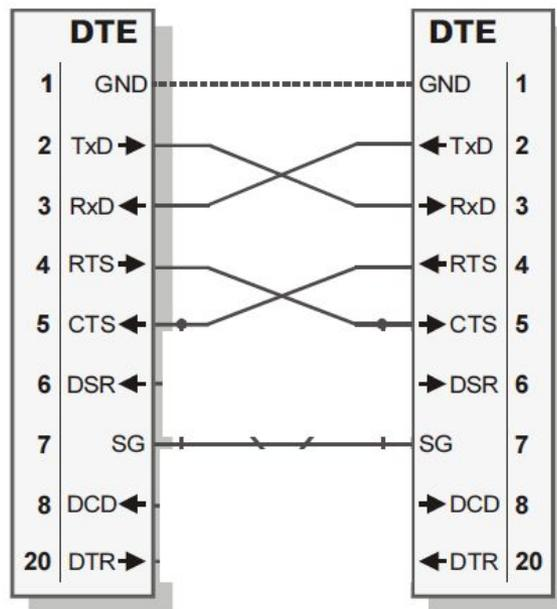
Возможность управления отдельными линиями порта при работе с не стандартными устройствами (три сигнала на выход **DTR, RTS, Tx** и четыре на вход **DSR, CTR, DCD, RI**)
