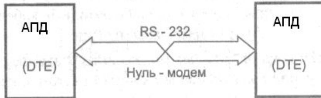
Рис. 3. Соединение по RS-232C нуль-модемным кабелем
