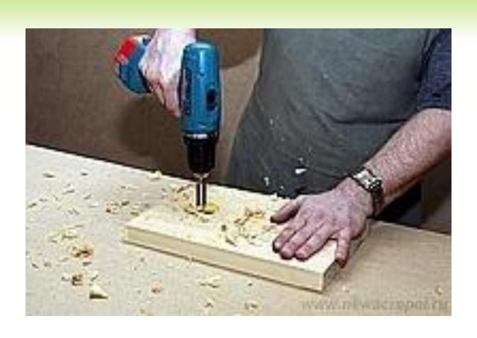
**4.** В передней и задней стенках скворечника просверлите отверстия диаметром 4 мм под саморезы по всему периметру стенки на расстоянии 1см от края. Достаточно 2-3 отверстия на сторону.
