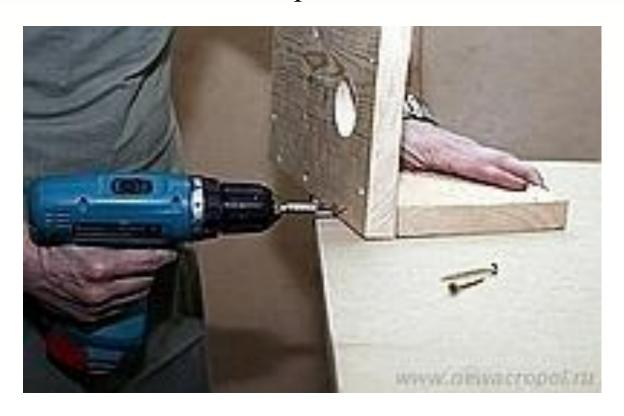
**3.** Полученные две части соедините саморезами друг с другом, обязательно примерив при этом донышко скворечника и нижнюю часть крышки.
