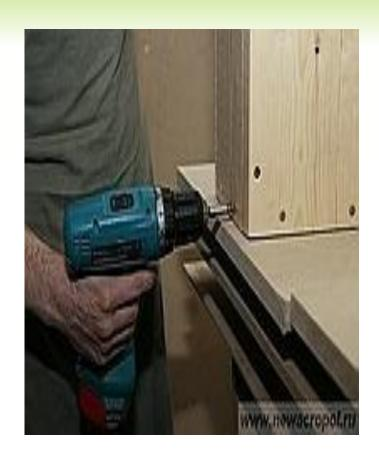
**5.** Соедините нижнюю часть крышки скворечника с верхней частью. Центр нижней части должен быть смещен от центра верхней части на 5 см, чтобы получился козырёк.
