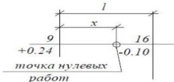
Рис. 5. Точка нулевых работ
