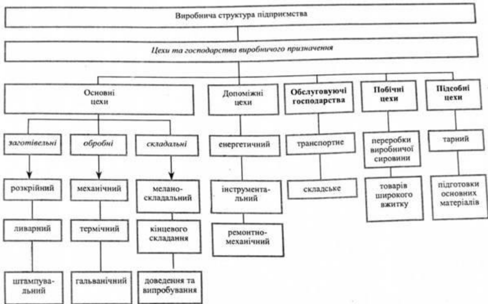
Рис. 1. Схема виробничої структури машинобудівного підприємства
