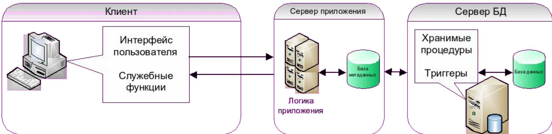
Трехуровневая модель, являющаяся расширением двухуровневой модели с введенным дополнительным промежуточным уровнем между клиентом и сервером, была предложена для разгрузки сервера
