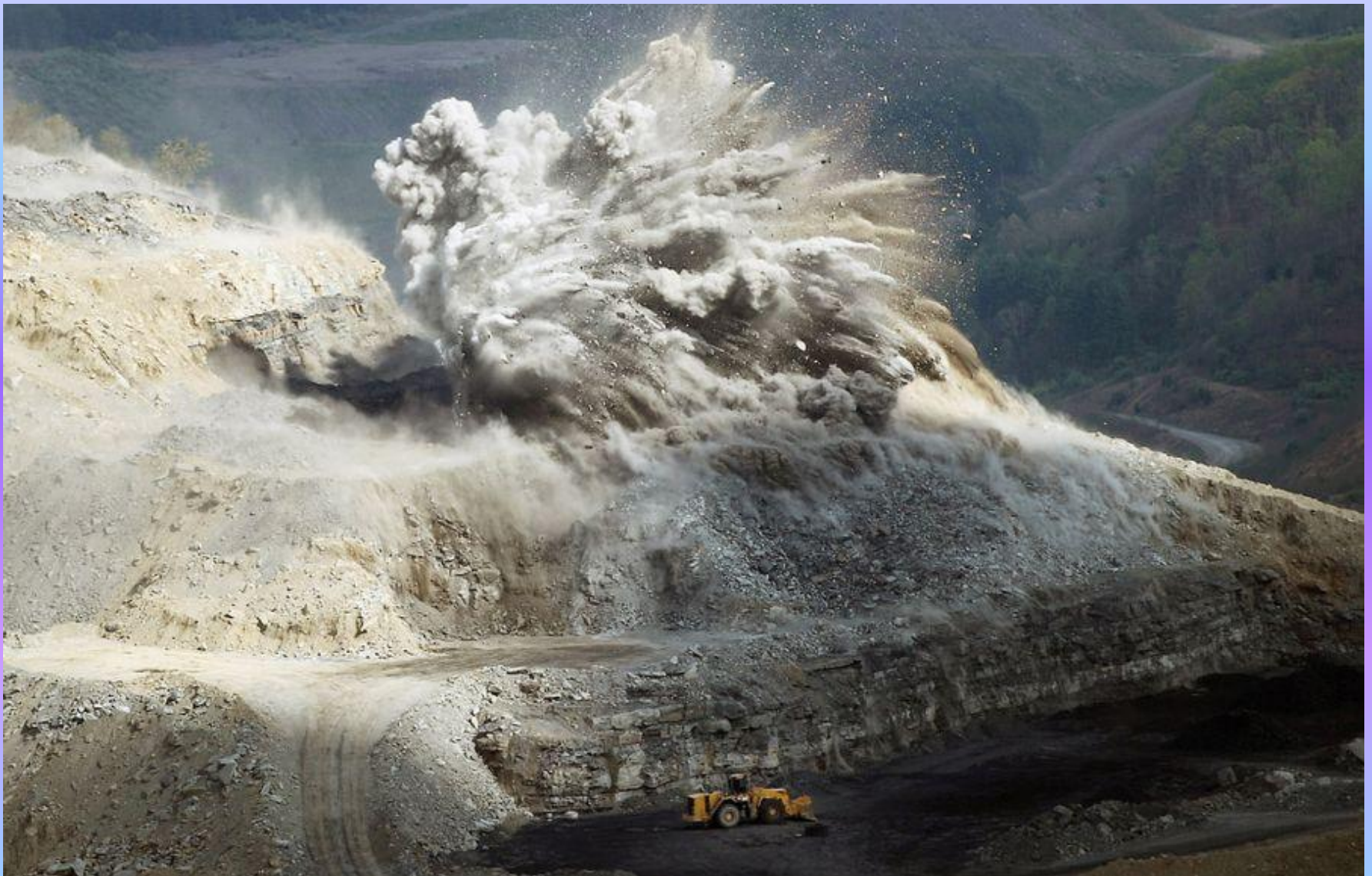
Взрывные работы. Идет добыча угля.
