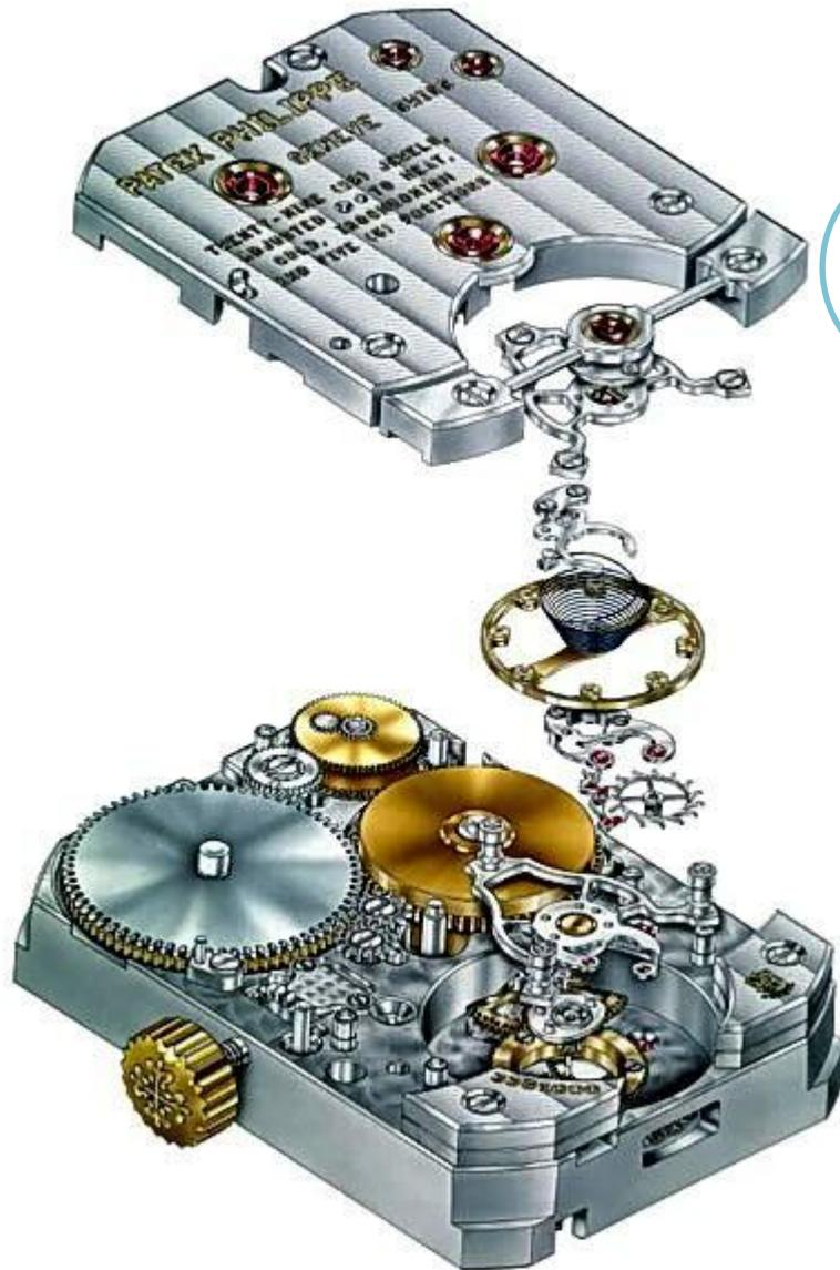
Прошло много времени с тех пор, когда человек придумал часы с механизмом. Внутри их поставил пружину, закрутил её, а чтобы она не раскручивалась, прикрепил к ней зубчатое колёсико. Оно цепляется за другое колёсико и вертит его. Второе же колёсико вертит стрелки.
