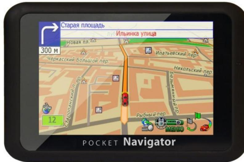
**Навигатор** – это специальное устройство, которое предназначено для определения своего местоположения с помощью глобальной спутниковой системы позиционирования
