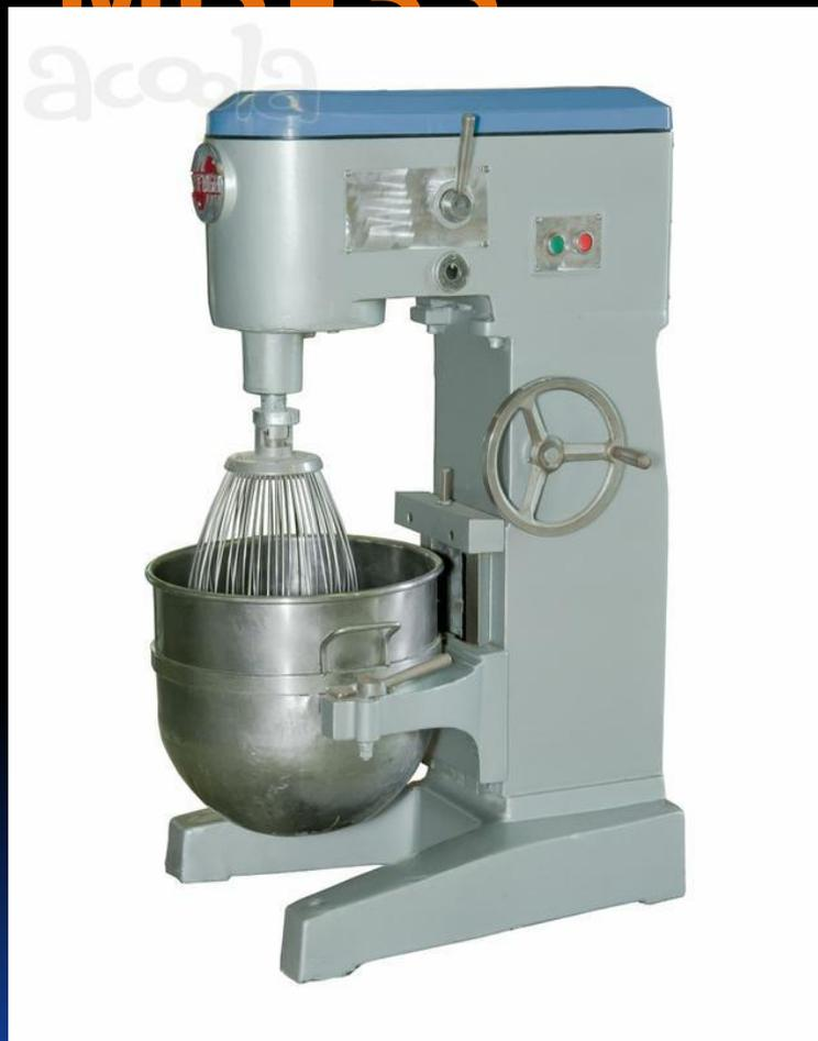
*На передвижном кронштейне крепиться съёмный бак. С помощью рукоятки или кнопок управления кронштейн перемещается в вертикальном направлении. Сменные механизмы взбивателей крепятся к рабочему валу с помощью штифта и фигурного выреза.*
