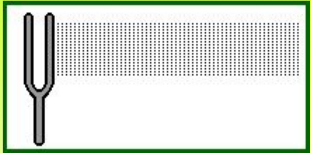
*Камертон* - (нем. Kammerton), источник звука, представляющий собой изогнутый и закрепленный посередине металлический стержень, концы которого могут свободно колебаться укрепленную на ящичке, у которого нет одной стенки. Если специальным резиновым молоточком ударить по стержню камертона, то он будет издавать звук, называемый музыкальным тоном.
