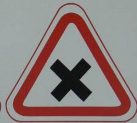
ПЕРЕСЕЧЕНИЕ РАВНОЗНАЧНЫХ ДОРОГ
