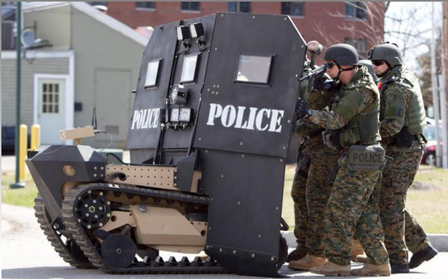
**Робот SWAT используется в качестве защитного щита для офицеров.**
