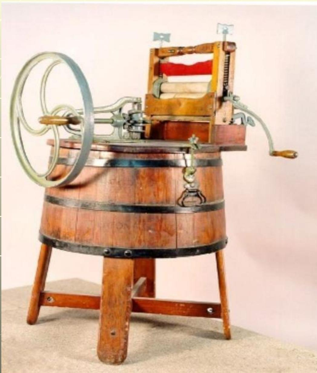
**1851 г. Американец Дж. Кинг запатентовал первую машину с вращающимся барабаном. Ее главная особенность – ручной привод, запускаемый специальной ручкой, как у мясорубки. Именно это изобретение стало первым прототипом современной СМ.**
