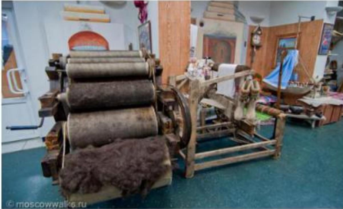
*Шерсть прогоняют через шерстобитную машину, в результате получается тонкое, мягкое полотно.*
