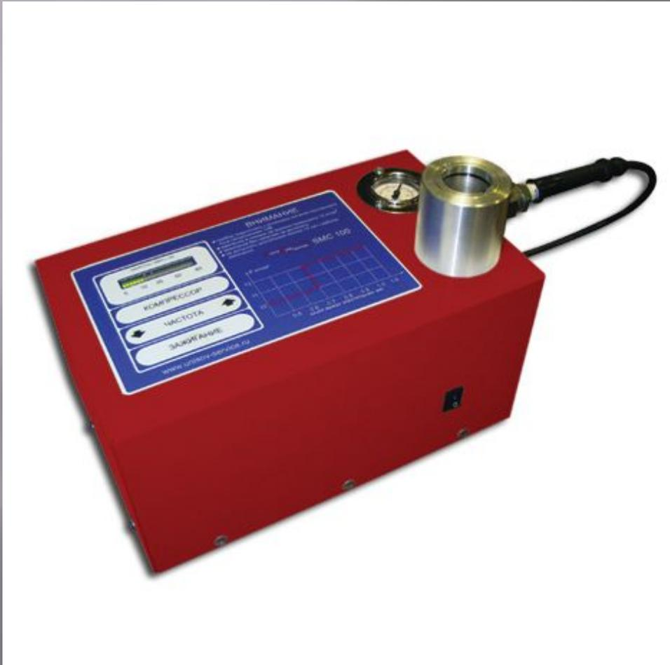
Стенд предназначен для диагностики свечей зажигания двигателей внутреннего сгорания. Диагностика производится под давлением до 12 атм., которое создается в специальной герметичной камере, оборудованной зеркалом. Режимы искрообразования соответствуют 1000-6500 об./мин.
