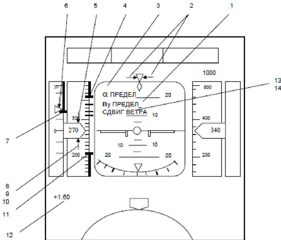
4,5 - индекс и сигнализатор максимально допустимой скорости  $V_{\text{МАКС}}$
