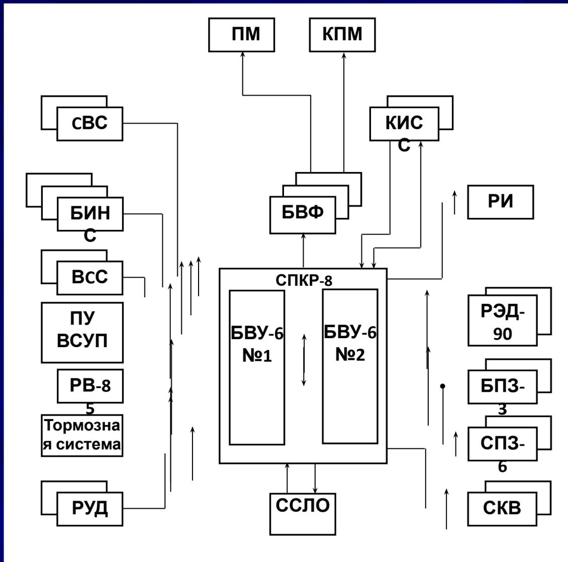
СПКР-85 состоит из двух вычислителей предупреждения критических режимов типа БВУ-6, которые идентичны между собой и взаимозаменяемы. При смене вычислителей вновь устанавливаемые не требуют регулировки и подгонки. Применение двухкратного резервирования вычислителей СПКР-85 повышает надежность и безопасность эксплуатации СПКР-85.
