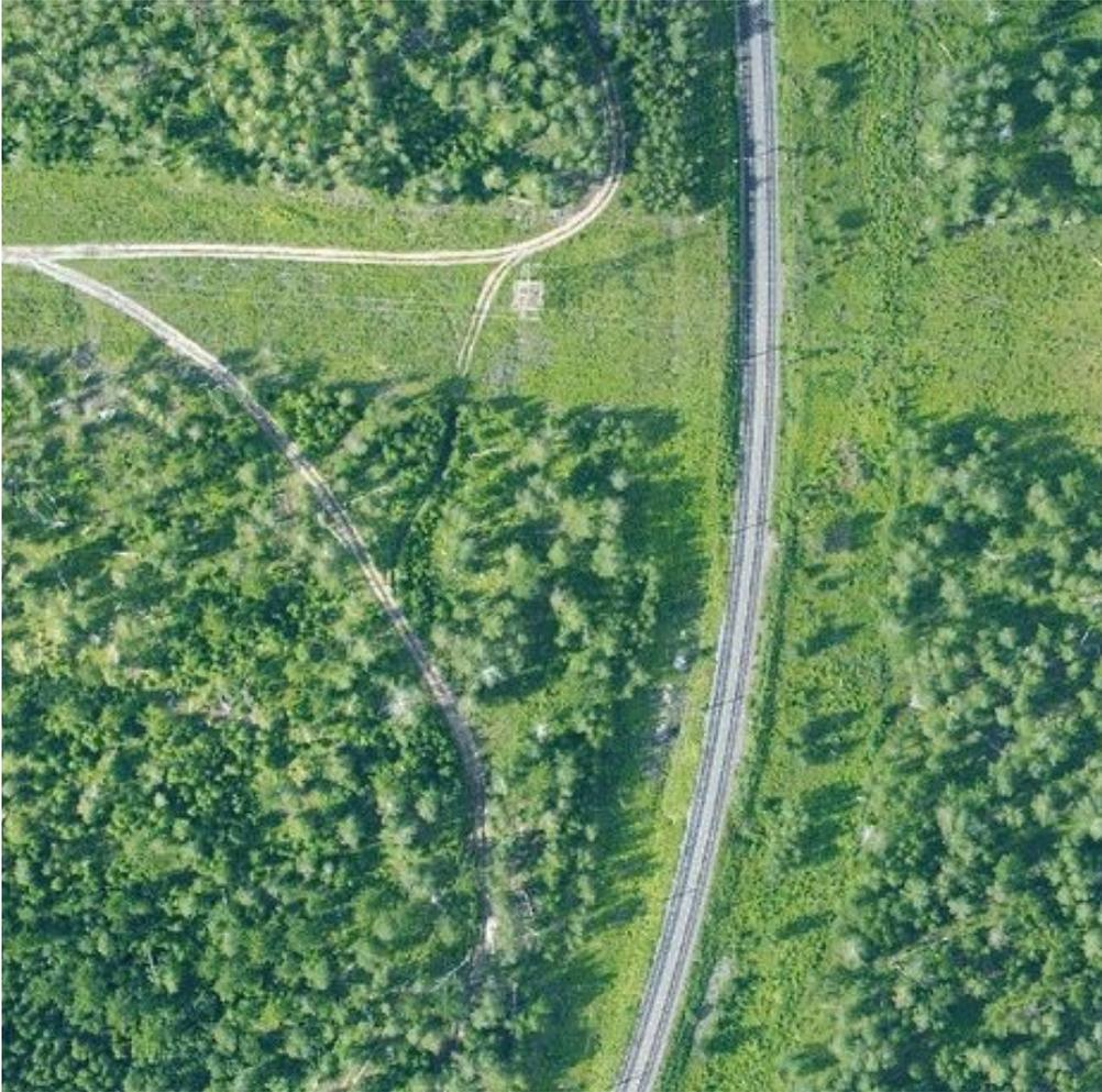
Ортофотопланы представляются в виде растрового изображения нужного масштаба в определённой системе координат. Ортофотоплан не имеет искажений за рельеф, каждая его точка имеет координаты и определяется на местности с высокой точностью. Ортофотоплан может использоваться как готовый продукт — законченный результат обработки воздушно-лазерного сканирования или используют в качестве подложки для создания топографического плана.
