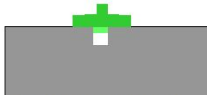
Проявитель вытягивает пенетрант на поверхность
