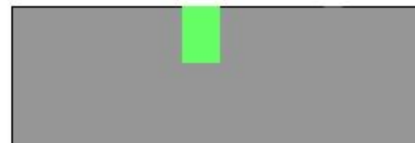
Пенетрант остался внутри трещин и расслоений
