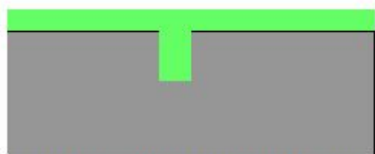
Выждать примерно 20 мин для внедрения пенетранта в трещины
