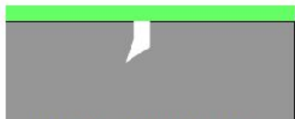
Нанесение пенетранта на поверхность
