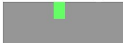
Пенетрант остался внутри трещин и расслоений
