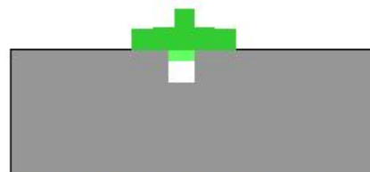
Проявитель вытягивает пенетрант на поверхность
