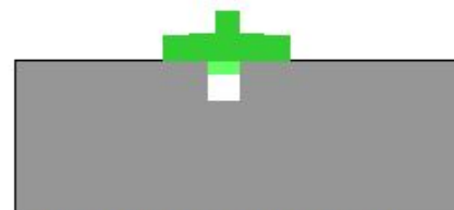
Проявитель вытягивает пенетрант на поверхность
