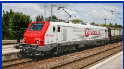
Prima – 3 системный– 4 200 кВт
