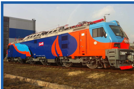
ЭП20–2 системный- 6 600 кВт
