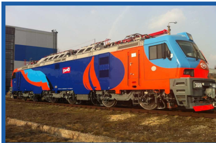
ЭП20–2 системный- 6 600 кВт
