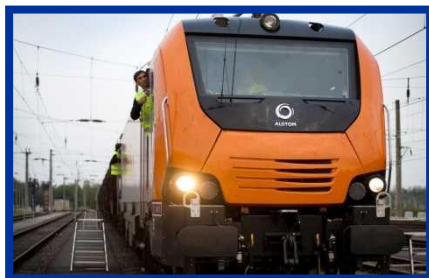
Prima II –4 системный – 6 400 кВт
