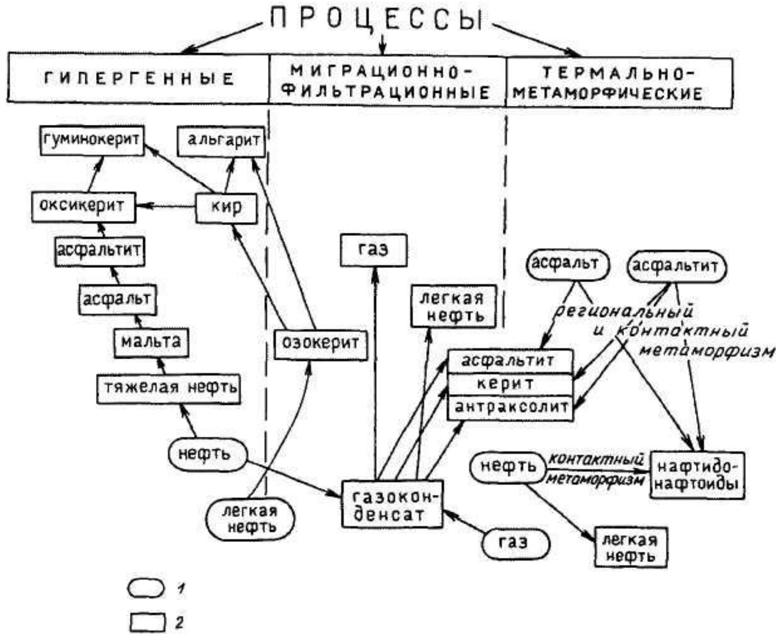
Рис. 1.19. Схема образования нефтидов различных генетических линий в природе: 1 — первичный продукт, 2 — новообразованный продукт
