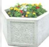
Цемент можно купить повсюду, материал это недорогой, простой в применении, изделия из него пригодны к использованию в любых климатических условиях. Бетон для цветочницы состоит из цемента, наполнителя и воды, смешанных в пропорции 2:6:1. В качестве наполнителя в основном используют песок или мелкий гравий, но чтобы снизить вес изделия, применяют также опилки, керамзит или торф. Из смеси цемента и крупнозернистого песка получается шероховатая поверхность. Для получения
