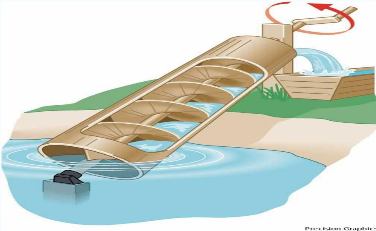
Издавна архимедов винт применялся для подъёма воды в оросительные каналы. Архимедовы винты использовались в установках по обработке сточных вод, потому что они успешно справляются с разными мощностями потока и с суспензиями.
