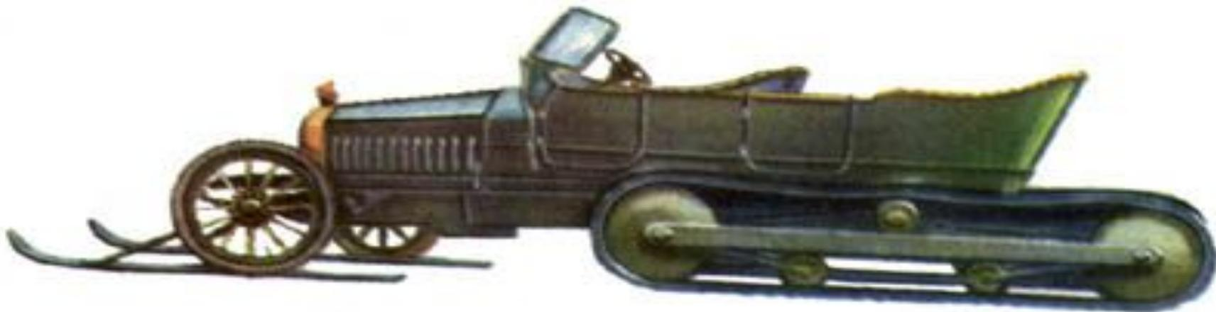
По идеям французского изобретателя А. Кегресса (1879-1943), работавшего в Петербурге, несколько машин были оснащены полугусеничным ходом. Тележка с лентами из прорезиненной хлопчатобумажной ткани монтировалась вместо задних ведущих колес. Передние колеса зимой оснащали лыжами. Автомобиль мог развивать скорость до 60 км/ч и легко шел по снежной целине.
