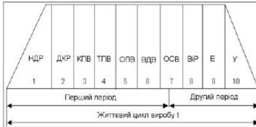
Рис. 1.1. Структура життєвого циклу виробу.
