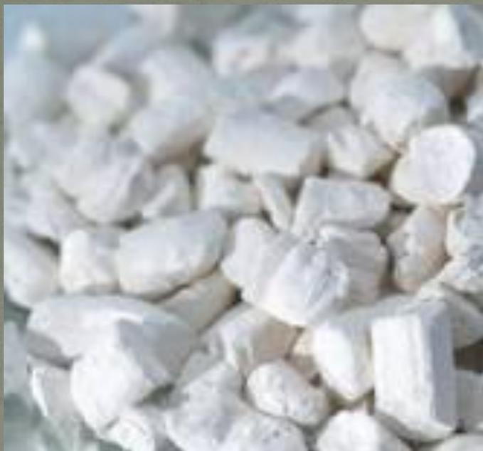
Смешение в соответствующей пропорции древесной массы и целлюлозы получают бумажную массу, из которой вырабатывают бумагу. Чтобы получить бумагу с ровной и гладкой поверхностью, бумажную массу наполняют, т.е. добавляют к ней каолин (белую глину), который заполняет промежутки между мельчайшими волокнами древесины и все неровности бумажного слоя.
