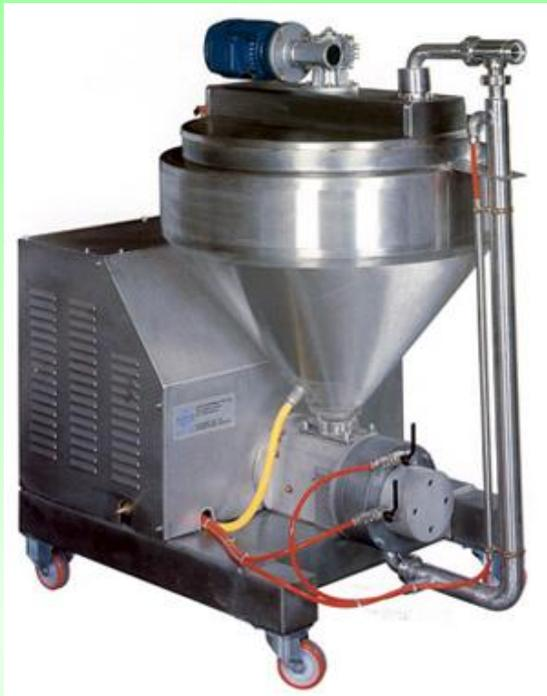
Для выработки карамели с начинками, которые закачиваются насосом, на корпусе машины смонтирован начинконополнитель. Он служит для дозированной подачи начинки внутрь карамельного батона.
