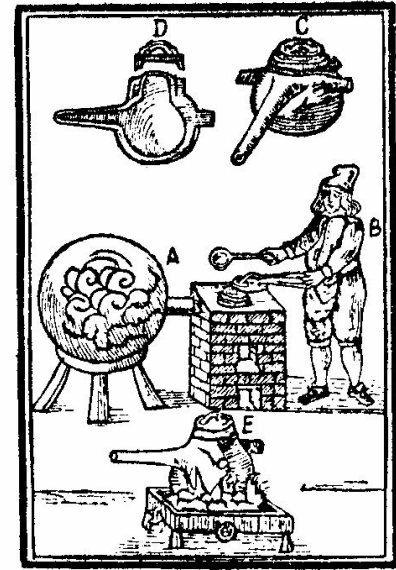
Рис. VIII-23. Получение серной кислоты в XVI веке.
