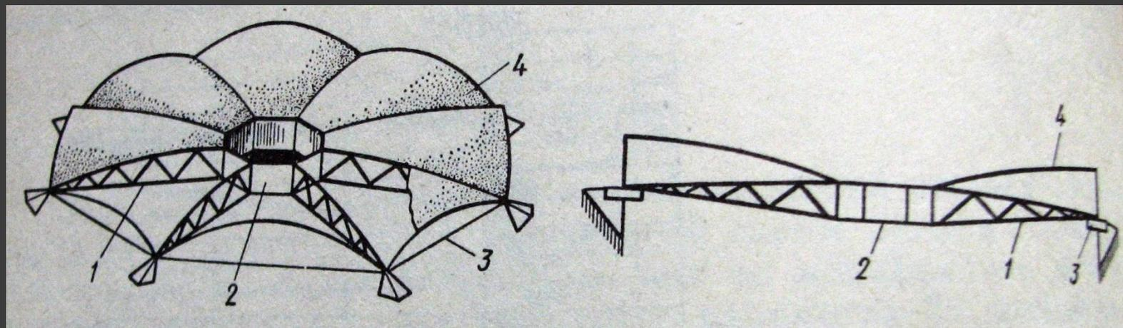
◎ Составные висячие покрытия возводят с центрическим планом. Они образуются криволинейной плитой из отдельных, сопряжённых в радиальном направлении оболочек двойкой кривизны; радиальными несущими элементами в виде двухпоясных вантовых ферм; наружным и внутренним контурами.
