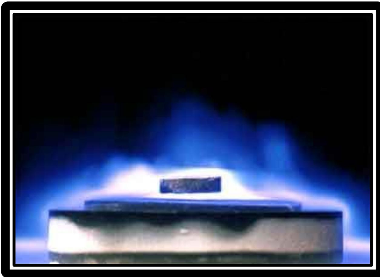
**Сверхпроводники – это идеальные проводники, обладающие дополнительным свойством: металл в сверхпроводящем состоянии не позволяет магнитному потоку проникнуть во внутрь.**
