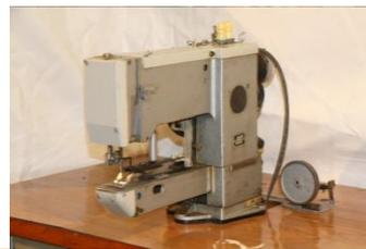
Машина-полуавтомат предназначена для пришивания плоских пуговиц с двумя и четырьмя отверстиями на пальто и костюмы однониточным цепным переплетением (тип 101). Частота вращения главного вала 1500 мин, пуговицы диаметром 36 мм пришиваются за 20 проколов иглы. Иглы 0141 № 90-130 (ГОСТ 22249-82 Е).
