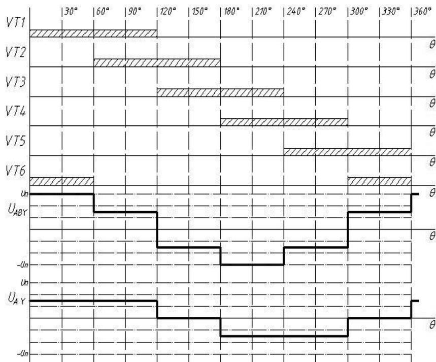
Алгоритм формирования напряжения при несимметричном управлении. Угол открытия 120град.  $U_n$ —напряжение звена постоянного тока,  $U_{ABY}$ ,  $U_{AY}$ —соответственно линейное и фазное напряжения на активной нагрузке, соединенной звездой.
