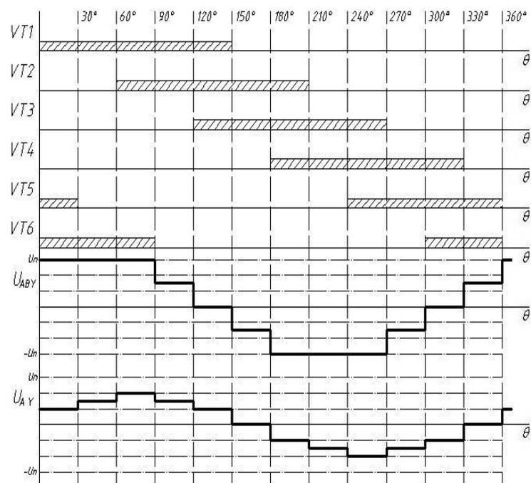
Алгоритм формирования напряжения при несимметричном управлении. Угол открытия 150град  $U_n$ —напряжение звена постоянного тока,  $U_{ABY}$ ,  $U_{AY}$ —соответственно линейное и фазное напряжения на активной нагрузке, соединенной звездой.
