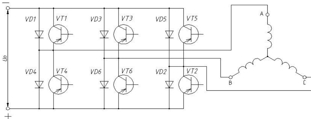
Принципиальная схема автономного инвертора, выполненного на транзисторах.
