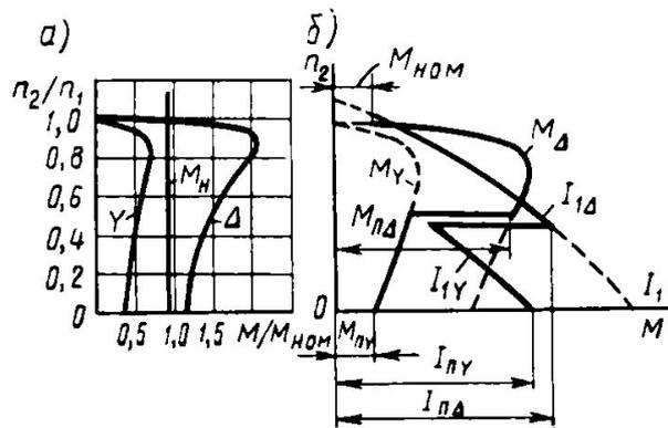
Рис. 5.3. Механические характеристики при включении обмотки статора по схемам Y и Δ (а) и графики изменения момента M и тока I<sub>1</sub> при пуске с переключением обмотки статора со Y на Δ (б)
