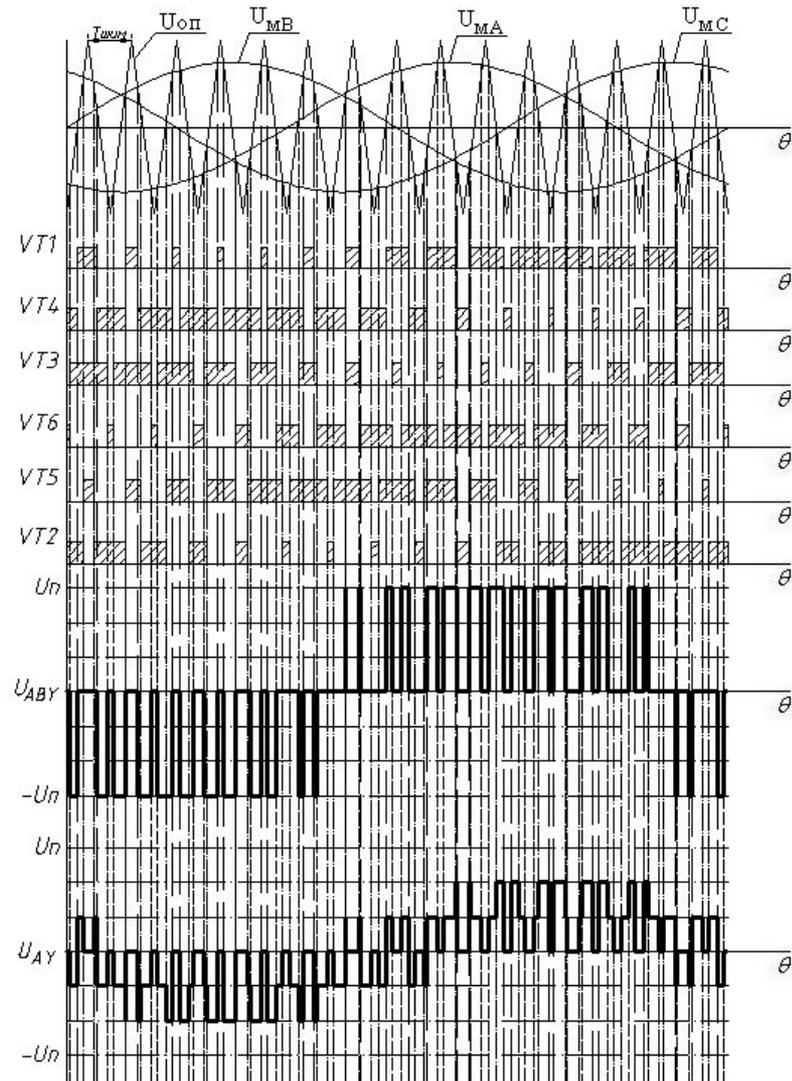
Алгоритм формирования напряжения при ШИМ по синусоидальному закону.  $U_n$  – напряжение звена постоянного тока,  $U_{АВУ}$ ,  $U_{АУ}$  – соответственно линейное и фазное напряжения на активной нагрузке, соединенной звездой.  $U_{мА}$ ,  $U_{мВ}$ ,  $U_{мС}$  – модулирующие напряжения.  $U_{оп}$  – опорное напряжение ШИМ;  $T_{шпм}$  – период опорного напряжения ШИМ.
