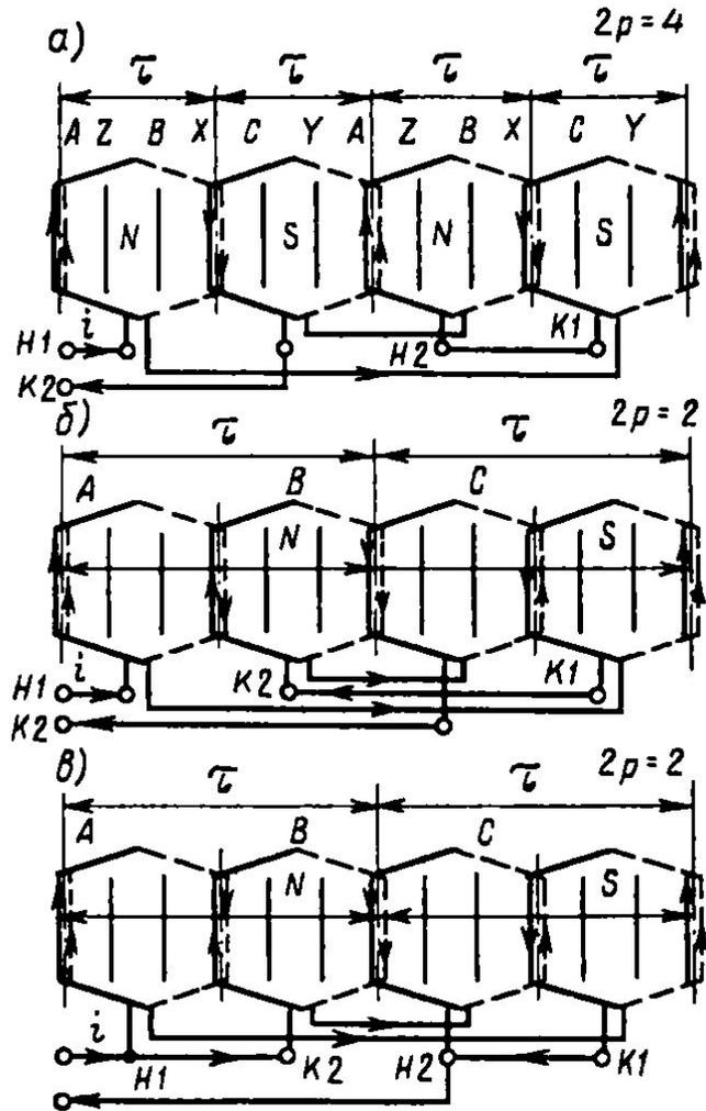
Рис. 6.17. Схема одной фазы полюсно-переключаемой обмотки:
