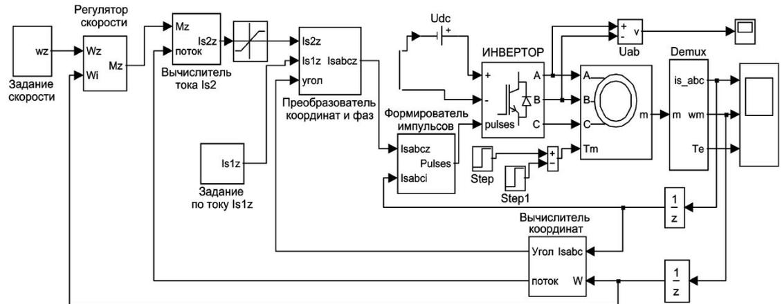
Рис.8.3.3 Структурная схема векторной системы управления
