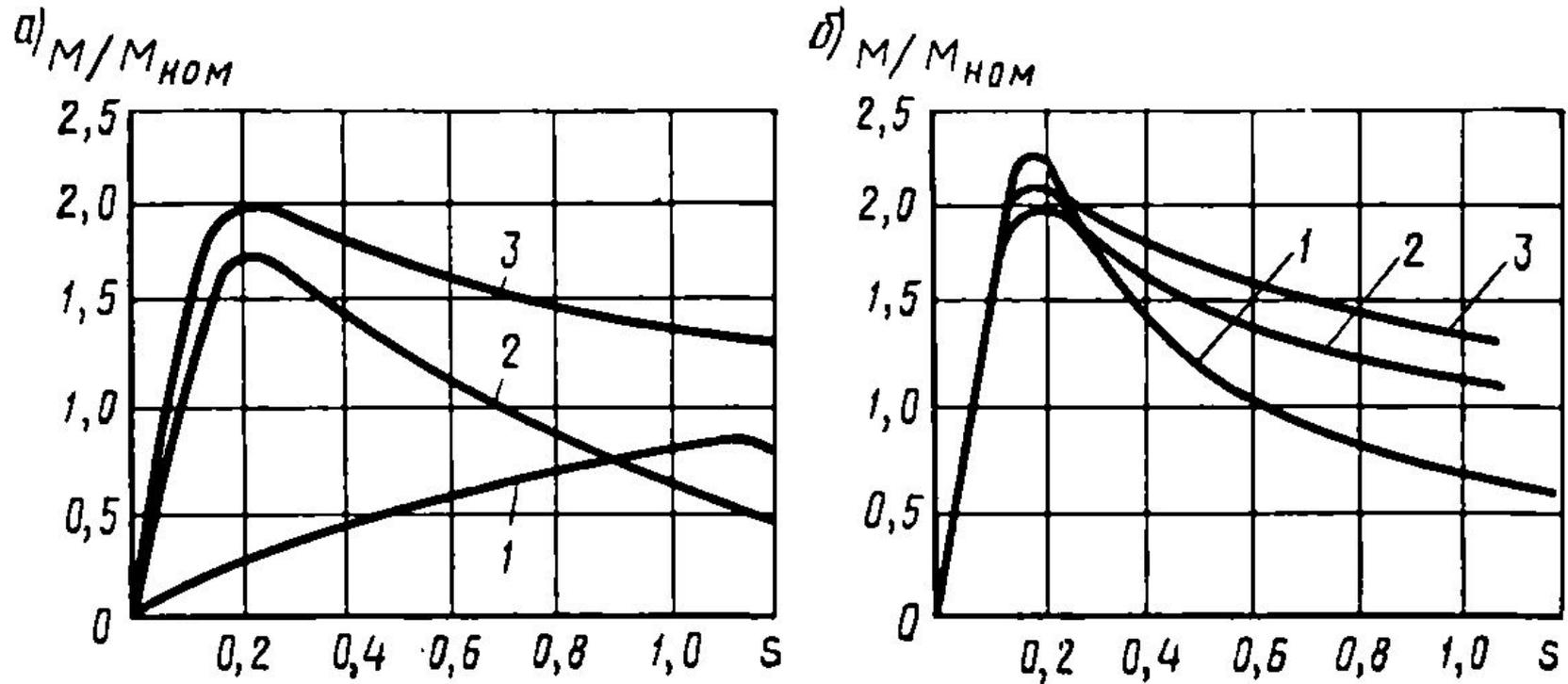
Рис. 5.8. Зависимости  $M=f(s)$  двигателя с двойной беличьей клеткой (а) и для машин с различным конструктивным выполнением ротора (б)
