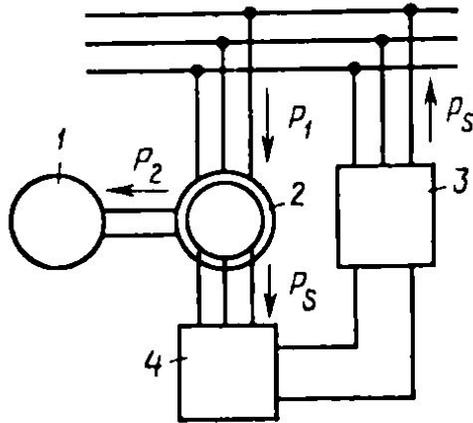
Рис. 8.12. Принципиальная схема вентильного каскада
