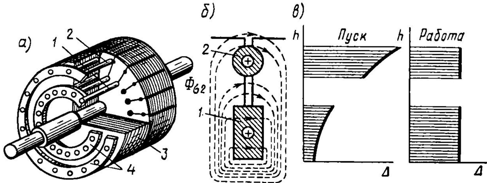
Рис. 5.7. Общий вид (а) и разрез паза (б) ротора двигателя с двойной беличьей клеткой и распределение плотности тока  $\Delta$  по высоте  $h$  в клетках при пуске и работе двигателя (в):
