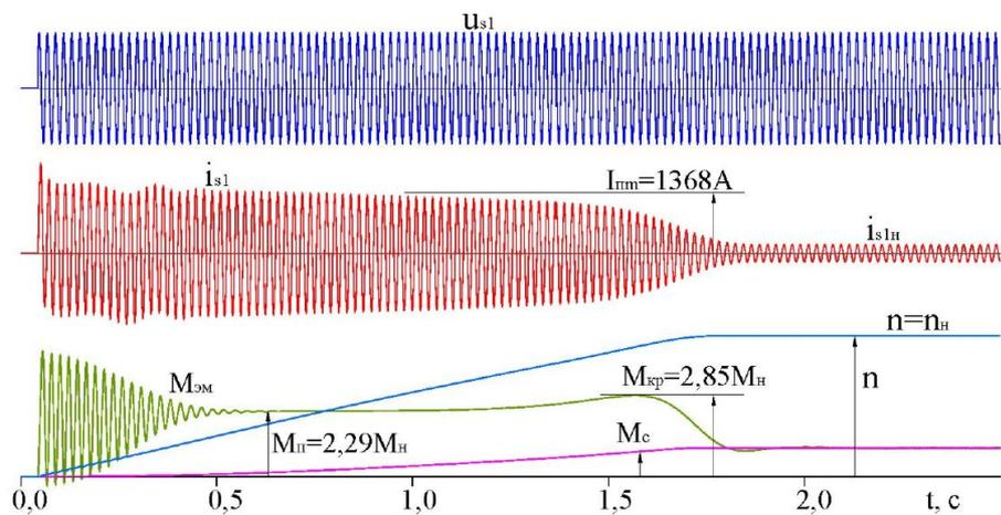
Рис. 7.1.3 Пуск двигателя мощностью 1250 кВт без ограничения тока
