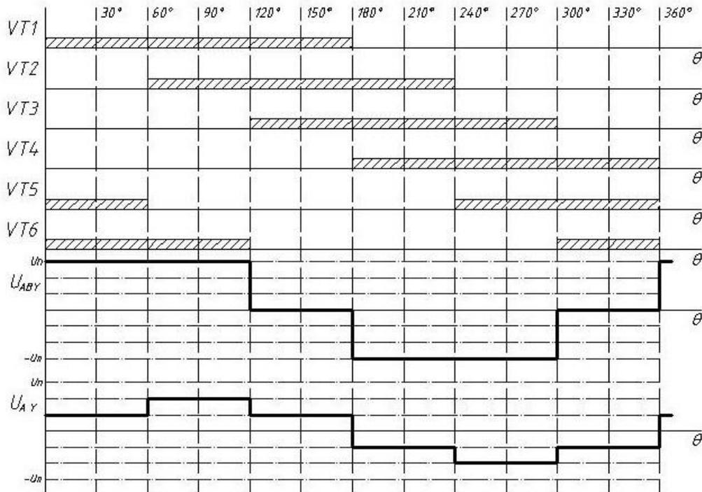
Принцип формирования напряжения при симметричном управлении.
