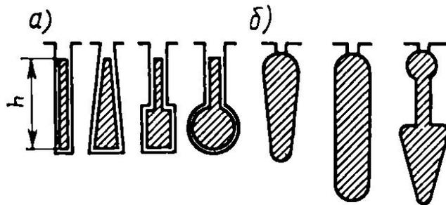
Рис. 5.12. Формы поперечного сечения стержней обмотки ротора асинхронных двигателей
