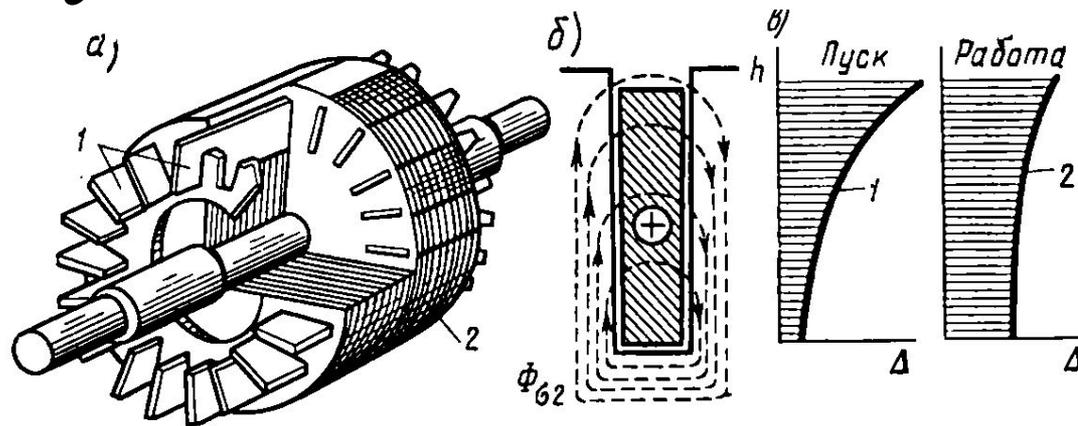
Рис. 5.9. Общий вид (а), разрез паза (б) ротора глубокопазного двигателя и разновидности пазов глубокопазных двигателей (в):
