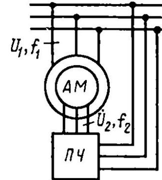
Рис. 8.9. Принципиальная схема асинхронного двигателя двойного питания
