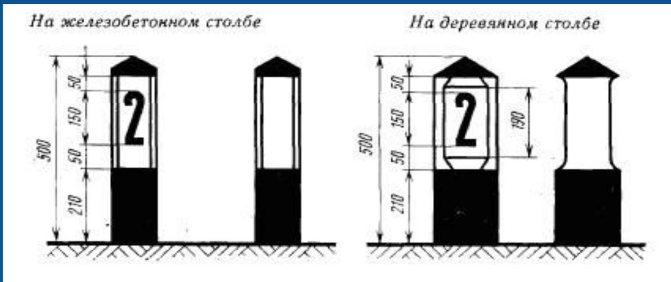
Пикетный знак делит километр на 10 частей и устанавливают его между километровыми знаками через 100 м. Порядковые номера пикетов изображают на двух противоположных сторонах, перпендикулярных оси пути, с одной стороны - номер окончившегося пикета, с противоположной стороны - начинающегося за знаком.
