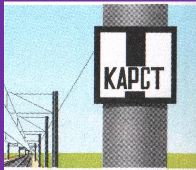
Устанавливаются в местах прохождения железнодорожных путей в закарстованных зонах непосредственно на опорах контактной сети или отдельных столбах.
