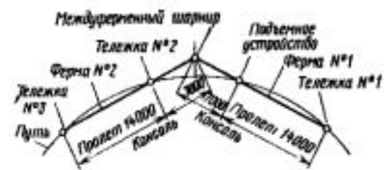
Рис. 5.8. Схема вписывания электробалластера в кривые
