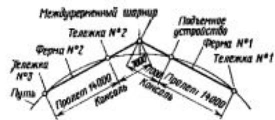
Рис. 5.8. Схема висяния электробалластера в кривые
