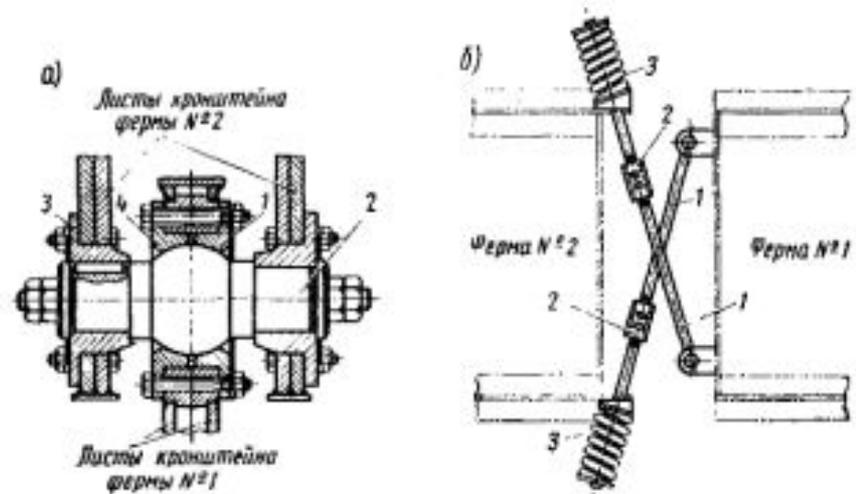
Рис. 5.9. Междурельсовое соединение:
