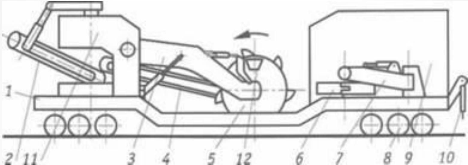
Рабочие органы: 1 - машина СЗП-600; 2 - тяговый модуль УТМ-1; 3 - вагон сопровождения ВП-1; 4 - поворотный конвейер; 5 - рама; 6 - стрела ротора; 7 - основной конвейер; 8 - ротор; 9 - крылья плуга; 10 - стрела плуга; 11 - трехосная тележка; 12 - кабина обслуживающего персонала; 13 - стабилизирующие опоры; 14 -бункер; 15 – опоры.
