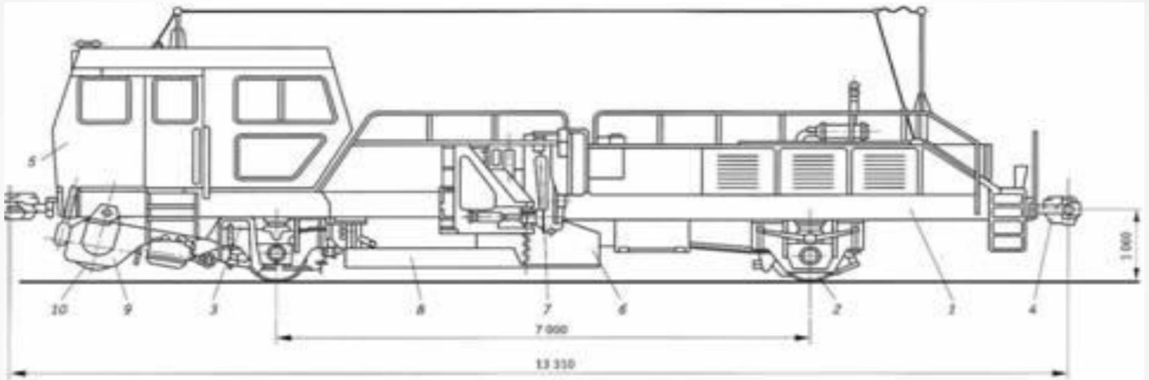
Схема: 1 — рама; 2 — колесная пара; 3 — рессорное подвешивание; 4 — автосцепка; 5 — кабина; 6 — центральный плуг; 7 — боковой плуг; 8 — туннели; 9 — подборщик; 10 — щетка
